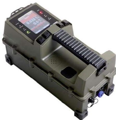
Εικόνα 13: Φορητός ανιχνευτής τύπου NaI, SpiR-ID Handheld Detection and Identification που διαθέτει το Εργαστήριο Ποιότητας Υδάτων και Αέρα (ΕΠΥΑ) του Τμήματος Περιβάλλοντος.
