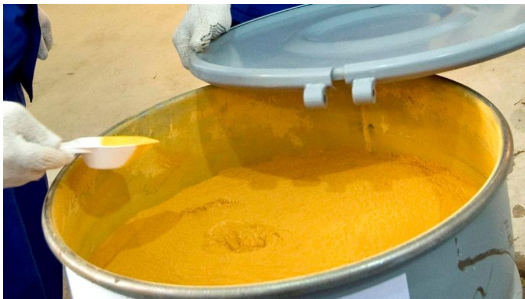
Εικόνα 2: Οξείδιο του ουρανίου «yellow cake» (Nuclear Energy Agency, Uranium oxide yellowcake. Photo: ©Shamil Zhumatov/Reuters).
