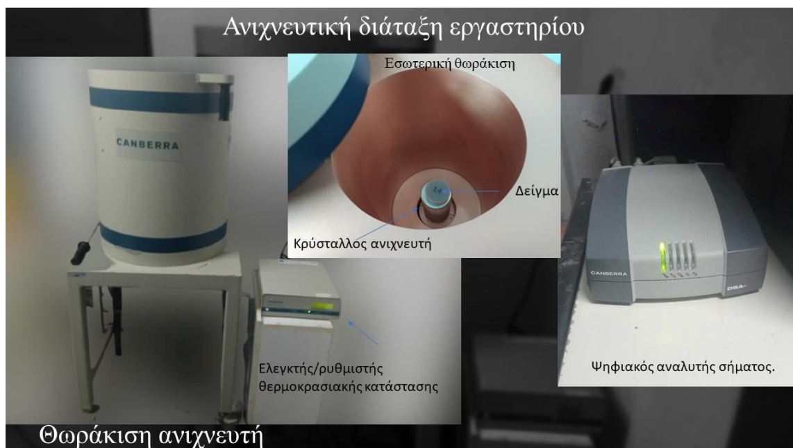
Εικόνα 10: Ανιχνευτής υπερκαθαρού γερμανίου που διαθέτει το εργαστήριο Ακτινοβολιών του Τμήματος Περιβάλλοντος, μοντέλο θωράκισης 747/747E, Model 7415 (Mirion, 2016).
